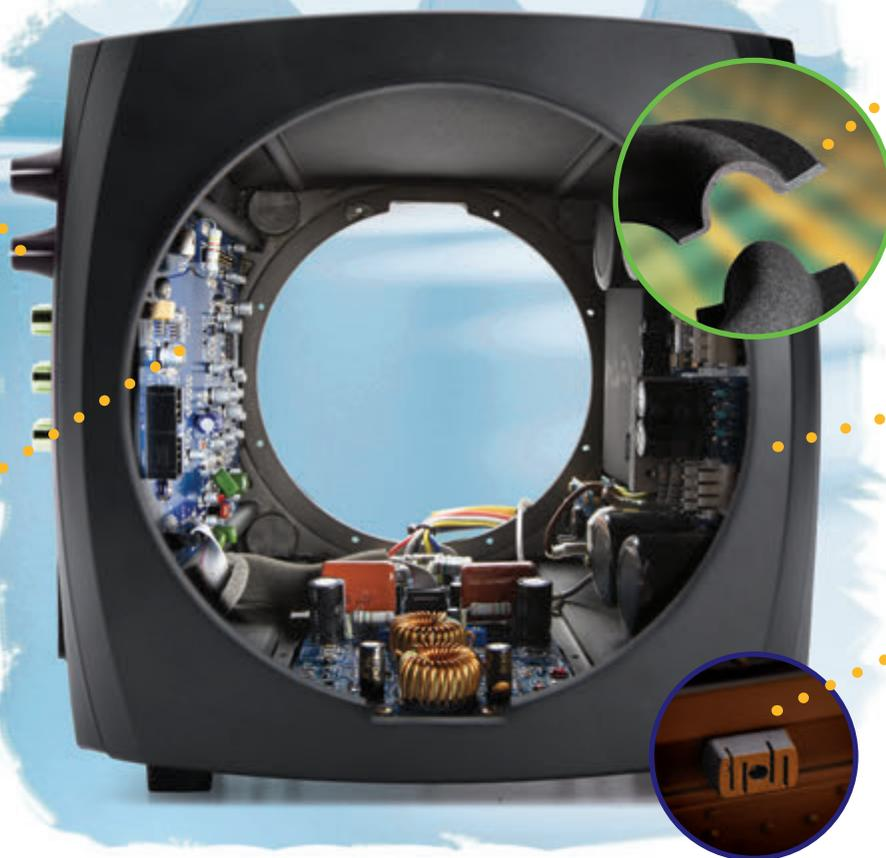
**Асимметричный кардиоидный подвес** изменяет плотность материала от внутренней стороны диффузора к внешней. Что это дает? Хорошо артикулированный бас, который сочетает экстремально мощный выход с очень низкими искажениями и исключительным качеством звучания.
